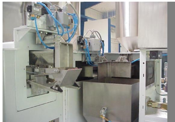
Abb. Klappwaage und Wiegebehälter
